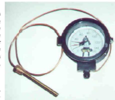
Ind. de temp. Máx. con reposición ext., con doble contacto, con bulbo a distancia.
